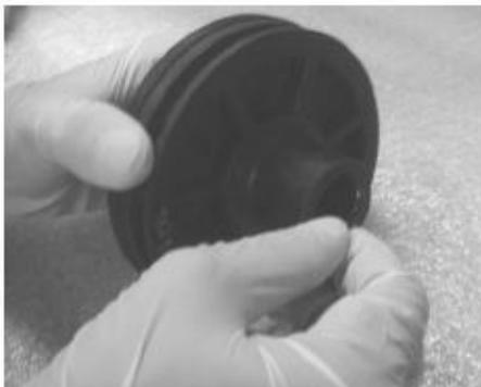
*Installing PWT Seal*
